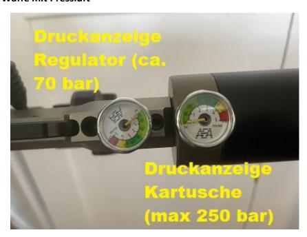
Das Gewehr verfügt über zwei Manometer (Druckanzeiger). Das zur Mündung gerichtete Manometer zeigt den Füllstand der Kartusche an. Sie sollten mindestens 100 bar Fülldruck aufrecht erhalten, aber nie mehr als 250 bar in die Kartusche hineindrücken.
